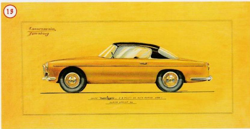
**13** - Ce dessin à échelle réduite (*figurino*) de la 1900C Super Sprint Touring de 2<sup>nd</sup>e série est signé Federico Formenti. Avec ses baguettes latérales chromées, ses butoirs de pare-chocs et son absence de répéteurs de clignotants, Il se distingue encore du modèle définitif. La forme du toit, soulignée par une décoration chromée lui donne l'allure d'un hard-top, *a fortiori* quand il est d'une couleur contrastée.
