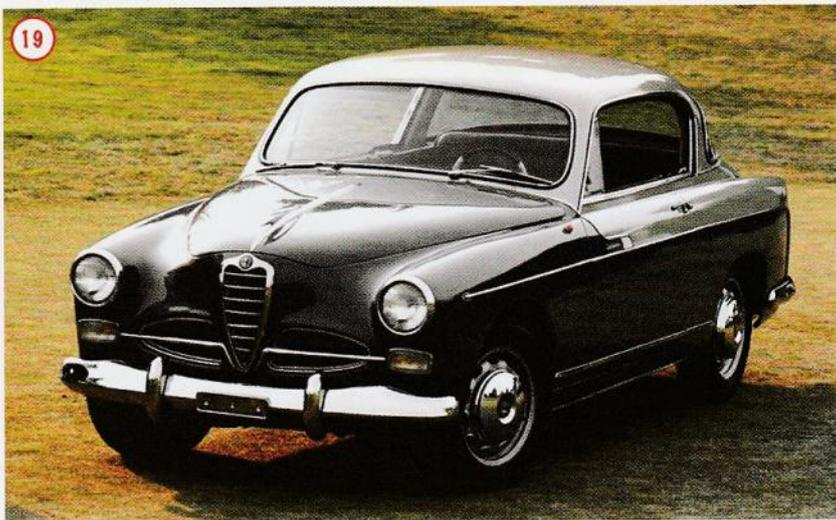
19 - Carrossé par Boano, le coach *Primavera* repose sur une plate-forme longue de berline Super. On voit ici un exemplaire de 2<sup>nd</sup>e série reconnaissable à la couleur du toit étendue à la partie supérieure des flancs et au couvercle de malle arrière. Remarquons les feux de position de forme rectangulaire, différents de ceux de la berline.
