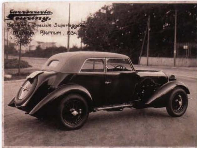
“Aternum” (come il fiume che bagna la città abruzzese). Le vetture, allestite per conto della Scuderia Ferrari, sono basate sul nuovo telaio Alfa Romeo 6C 2300. La struttura della carrozzeria semirigida (basata ancora sul sistema Weymann) introduce però alcuni elementi stilistici innovativi.
