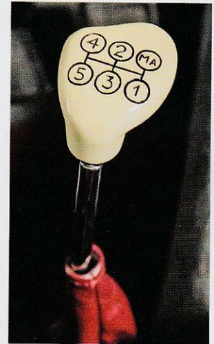
Il pomello del cambio delle Pegaso ha una forma molto caratteristica e l'indicazione delle marce che hanno una posizione nella griglia speculare a quella alla quale siamo abituati
