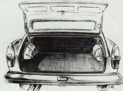
Il bagagliaio della «Primula coupé». La ruota di scorta è sotto al tappeto di gomma che ricopre il piano di carico. Il coperchio è contrappesato.
