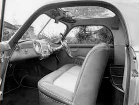
A sinistra il disegno del brevetto Aerlux, depositato da Felice Bianchi Anderloni nel 1946. Sopra, l'applicazione del brevetto Aerlux che donava aria e luminosità a tutto l'abitacolo.
